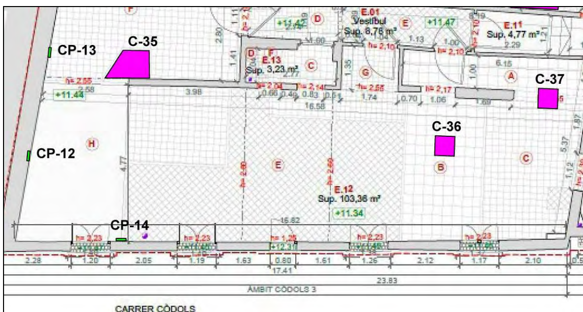
Planta de les Cales realitzades a la planta Segona de Dels Còdols, 3
