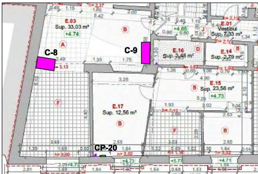
Cales realitzades a la planta principal de carrer dels Còdols, 3
